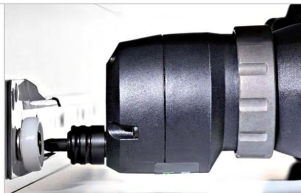
Работа «впритык». С помощью эксцентриковой насадки FastFix вы «достанете» любой шурп.
