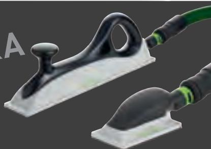
Некоторые проблемные участки лучше обрабатывать вручную. Теперь это также возможно без пыли, потому что новый ручной шлифок от Festool легко подсоединяется к пылеудаляющему аппарату. Мощность всасывания регулируется с помощью адаптера с байпасом. Углы липучки скруглены, так что поверхность не повреждается.
