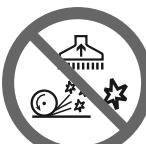
Nie odsysać żarzącego się pyłu lub innych źródeł ognia. Nie stosować w połączeniu z maszynami wytwarzającymi iskry!
