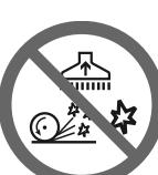
No aspire polvo incandescente ni otras fuentes de ignición. No utilice en combinación con máquinas que puedan desprender chispas.
