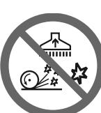
Keinen glühenden Staub oder andere Zündquellen aufnehmen. Nicht in Verbindung mit funkenerzeugenden Maschinen einsetzen!
